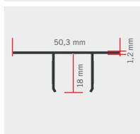
staffa di fissaggio guida laterale (per fissaggi laterali)
