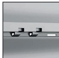
L'avvolgibile in PVC rinforzato **SOLE 4,5** (peso specifico standard di circa kg 4,500/mq) è realizzato con stecche auto-aggancianti (a doppia parete, con intersezioni di irrigidimento interni e rinforzi in resina) che misurano 13 mm di base e 55 mm di altezza.
